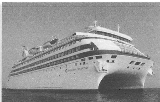
ラディソン・ダイヤモンド Radisson Diamond。SWATH 船型を採用したユニークなクルーズ客船である。(RADISSON SEVEN SEAS CRUISES)
